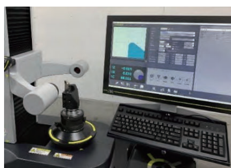
刃先寸法測定例 (非接触式ツールプリセッタ)
